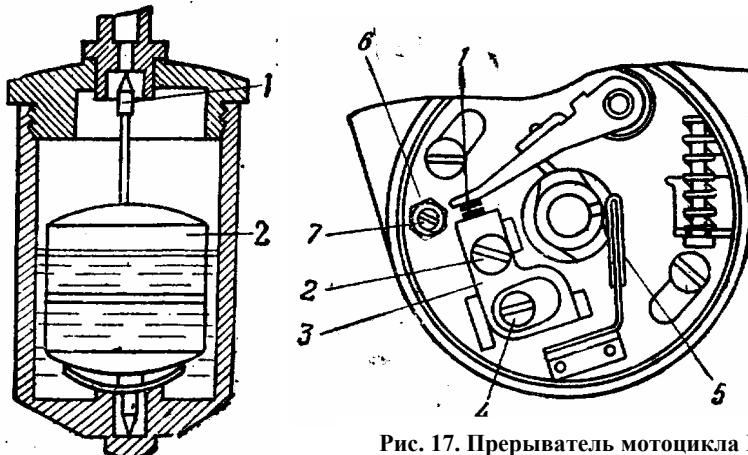
**Рис. 16. Поплавковая камера:**
