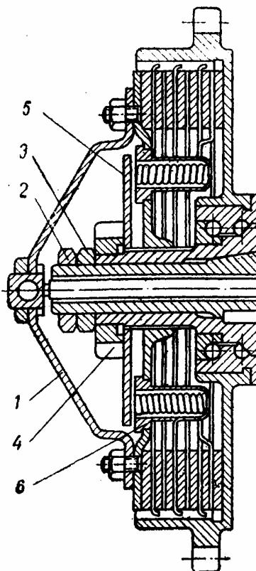
**Рис. 7. Муфта сцепления мотоцикла АМ-600:**
