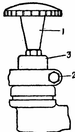
Рис. 12. Регулировка подшипников рулевой колонки:
