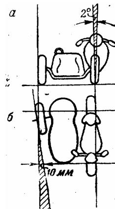
**Рис. 21.** Регулировка коляски:
